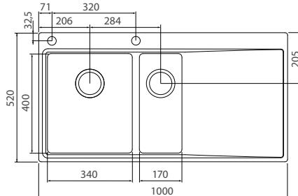
Nicho de corte para instalação (Semi-Flush)
