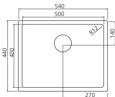
Nicho de corte para instalação (semi-flush)
