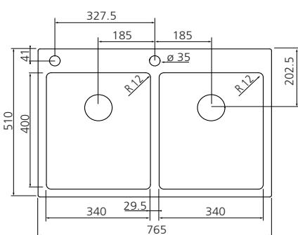
**Nicho de corte para instalação (Semi-Flush)**
