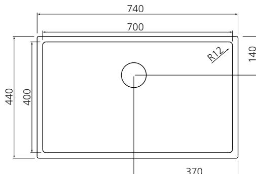
Nicho de corte para instalação (semi-flush)
