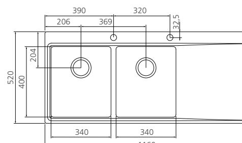
Nicho de corte para instalação (Semi-Flush)
