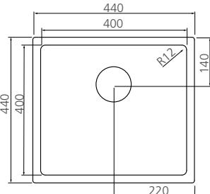
**Nicho de corte para instalação (semi-flush)**
