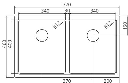
Nicho de corte para instalação (semi-flush)
