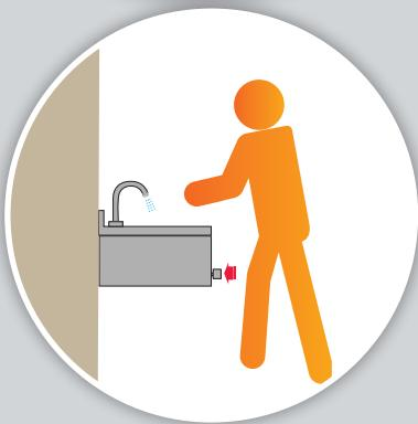
**A válvula para açãoamento da água foi projetada estratégicamente para ser açãoada com o joelho, não sendo necessário tocar com as mãos no lavatório para açãoar a torneira (exclusivo para o modelo 95000/004).**
