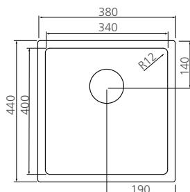
**Nicho de corte para instalação (semi-flush)**
