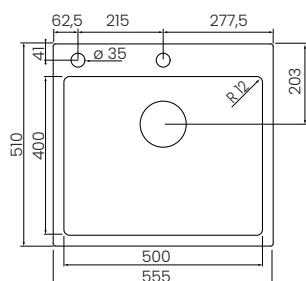
**Nicho de corte para instalação (Semi-Flush)**
